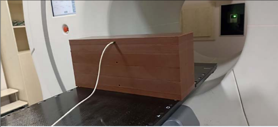
Şekil 3. Işın kalitesi testi için kurulması gereken ölçüm düzeneği.
