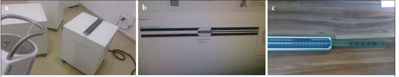
Şekil 6. (a) Mekanik cetvel ve cihazın bağlanı kurulmuş durumu, (b) demo plan, (c) ışınlanmış verifikasyon filmi ve mekanik cetvel.
