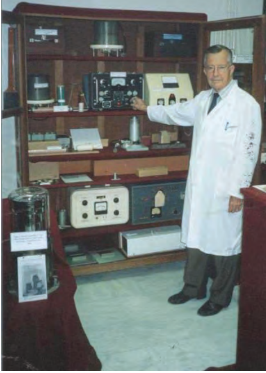
Türkiye’de ilk defa Enstitümüz’de Nükleer Tıp uygulamalarında kullanılan ölçüm cihazları dolabı: Geiger-Müller ve Sintilasyon (up-take) Sayıcıları; İyon Odaları (1954)
