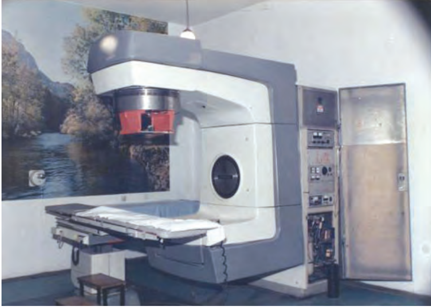
G-1 Türkiye’de ilk defa İ.Ü. Tıp Fakültesi Radyoterapi Kürsüsü’nde kullanılan megavoltaj radyoterapi cihazı. (1974) Siemens Mevatron 12 MeV lineer hızlandırıcı. X-ışını tedavisi: 8 MeV Elektron tedavisi: 3-5-7-9-12 MeV Kullanım Süresi: (1976-1991)
