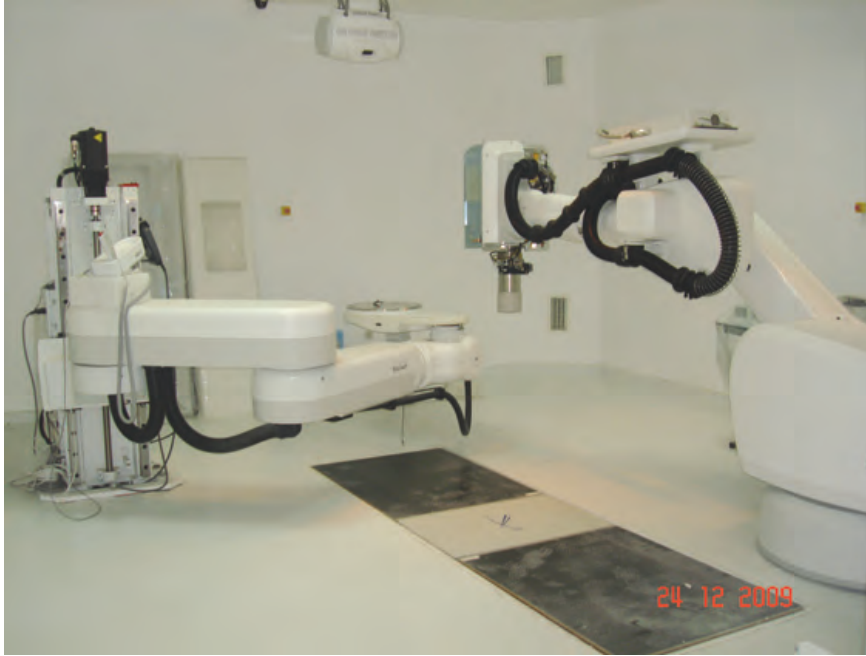
CYBERKNIFE: Uzay Neşteri, Robotic arm, IGRT Radyocerrahi yapan 6 MV lık Linear Hızlandırıcı kanser tedavi cihazı.
