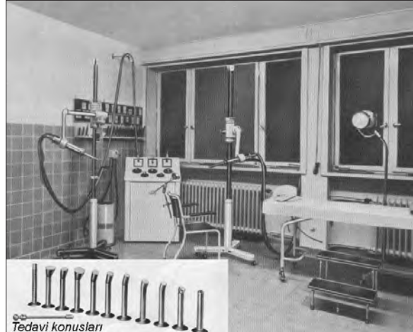
Siemens Chaoul X ışını tedavi cihazı. 60 KV 4mA, 2 tüplü intraoral-intravaginal ve yüzeysel lezyonların tedavisinde kullanılmıştır (Kullanım Süresi: 1943-1958).
