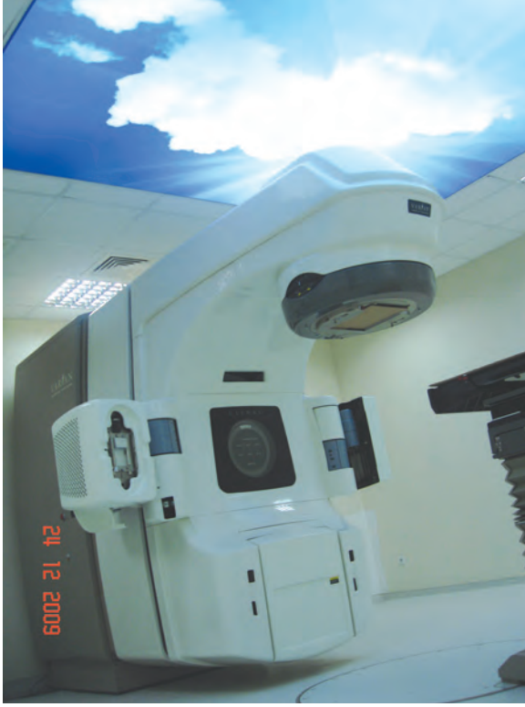
6-15 MeV lik IGRT yapabilen 120 MLC with EPID and IMRT, QA Varian Lineer Hızlandırıcı cihazının satın alınışı ve yeni inşa edilen özel binaya monte edilmesi.
