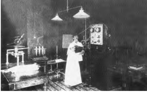
Şekil 5. Radyoterapinin ilk uygulaması (1902). Hamidiye Sultan Etfal Hastanesi'nde (Şişli) güçlendirilmiş gazlı Crookes katod ışını tüpü ve Rumkorff Bobini Kullanarak hastaların radyoterapisine başlandı. Radyoterapi odası (1902).
